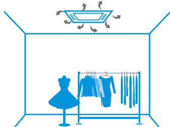
Rozkład powietrza z zabrudzonym filtrem
